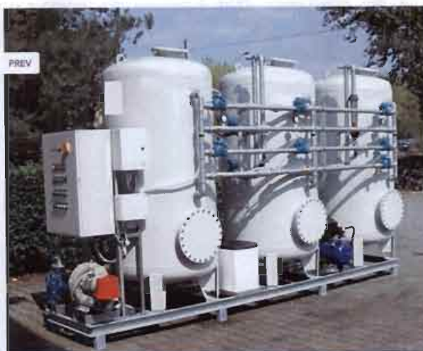
Foto impianto di trattamento dotato di n.3 filtri a c.a.
