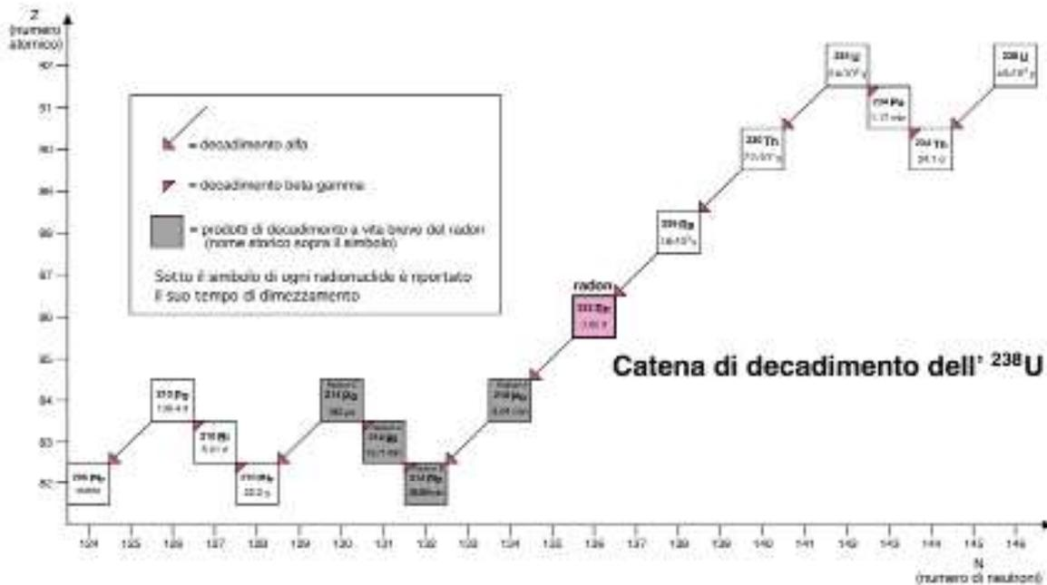
Figura 1: Schema della catena di decadimento dell' $^{238}\text{U}$  [2]
