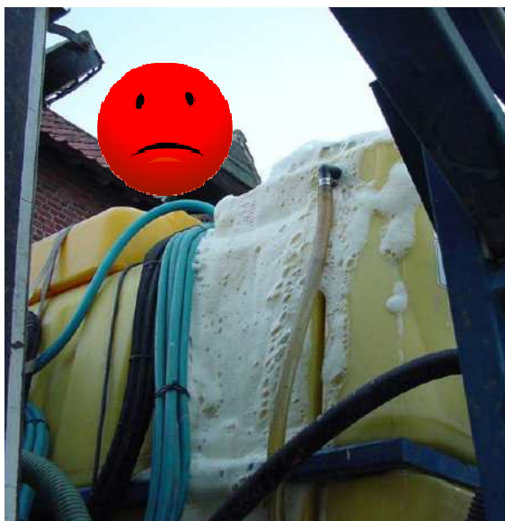
Fig. 52 – Traboccamento della miscela fitoiatrice dal serbatoio principale della macchina irroratrice (foto E. Nilsson – Visavi).
