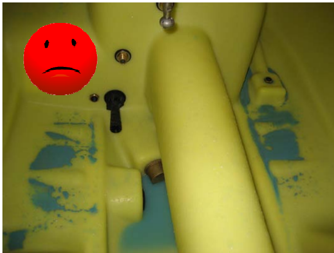
Fig. 36 – Miscela residua nel serbatoio poiché non aspirata dalla pompa (foto E. Nilsson – Visavi)
