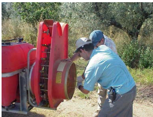
Fig. 149 – Regolazione dell'inclinazione delle pale.
