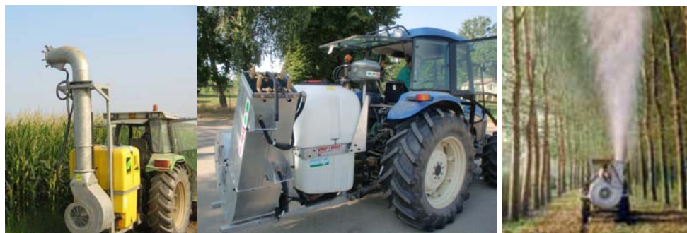
Fig. 182 - Esempi di irroratrici a cannone, molto sensibili alla deriva
