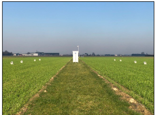
Figura 3: Prototipo per la misurazione in continuo e in tempo reale dei delle emissioni di GHG dal suolo. È possibile vedere le otto camere d'accumulo, quattro per ogni parcella monitorata. (Fonte: Matteo Ruggieri, Horta S.r.l.)
