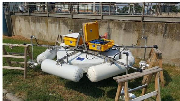
**Figura 3: Lo strumento innovativo Lessdrone, per la misura dell'efficienza di trasferimento dell'ossigeno e delle emissioni di gas serra nelle vasche di ossidazione (foto: LIFE LESSWATT)**
