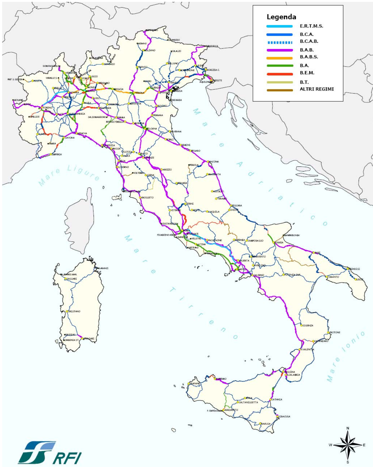
Figura 26 - Caratteristiche delle linee ferroviarie secondo i regimi di circolazione – Fonte: RFI
