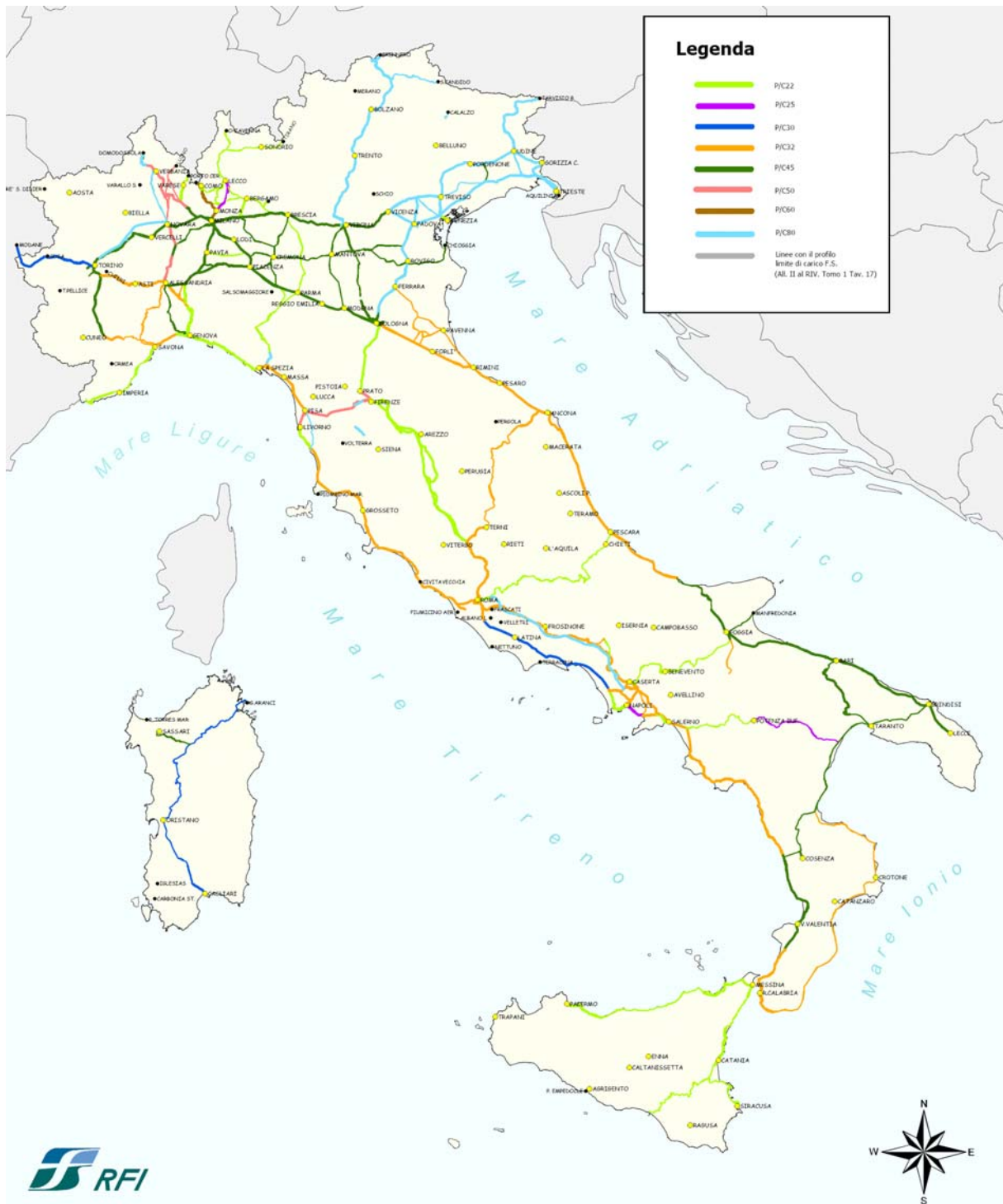
Figura 25 - Caratteristiche delle linee ferroviarie secondo la codifica per il trasporto combinato – Fonte: RFI
