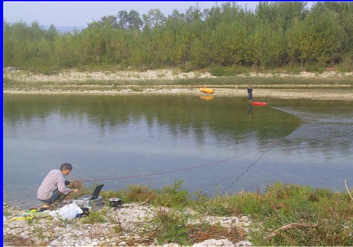
Misure di portata con ADCP e componenti della strumentazione.
