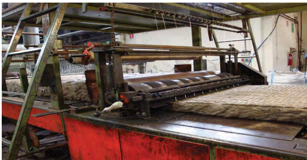
Fig. 3 - Produzione di lana di roccia da bottom ash e fly ash
