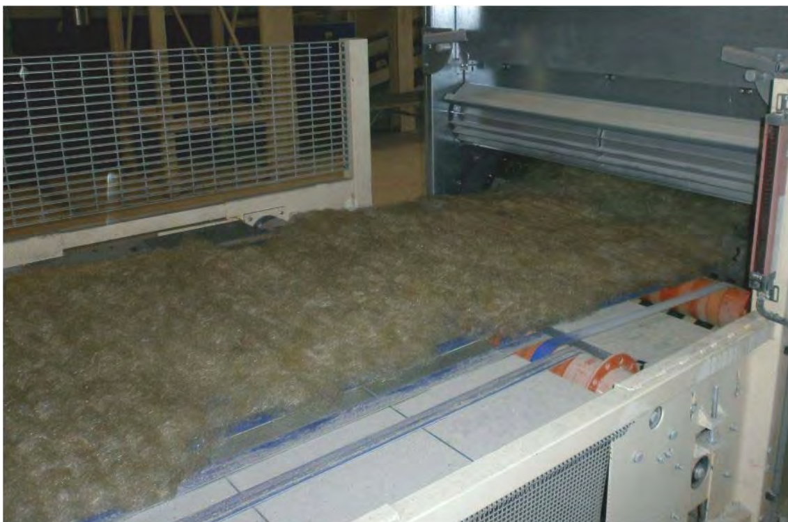
Fig. 9 - Formatura del materasso in lana di roccia
