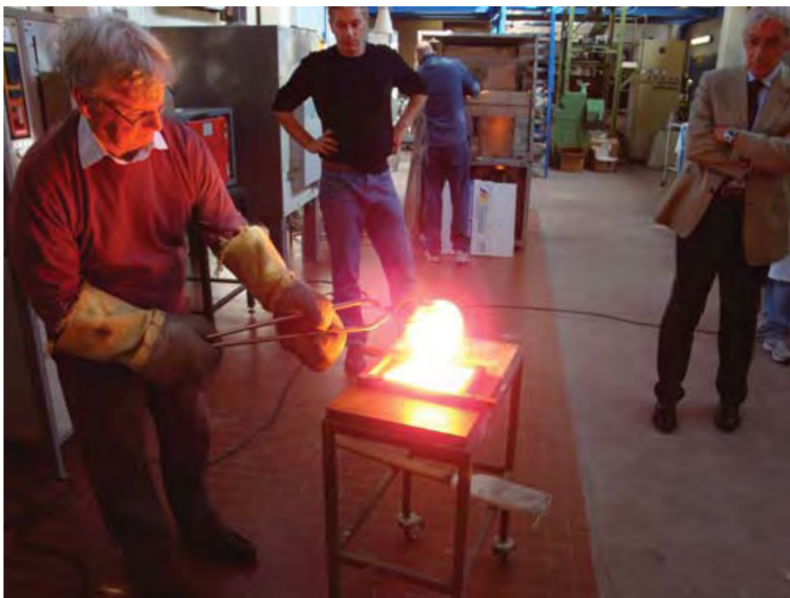
Fig. 2 - Produzione vetro per lana di roccia su scala di laboratorio
