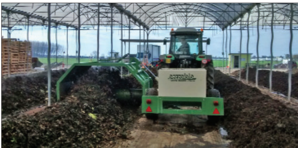
Figura 4. Voltacumuli in funzione.
