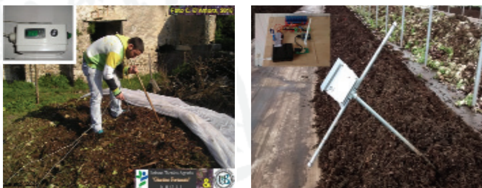
Figura 1. A sinistra: dispositivo semplificato per la misura della temperatura del cumulo con sonde; a destra: dispositivo senza fili per la misura dei gradienti di temperatura del cumulo con sonde PT100.
