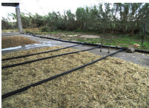
Figura 1. sistema di aerazione e letto di trinciato.
