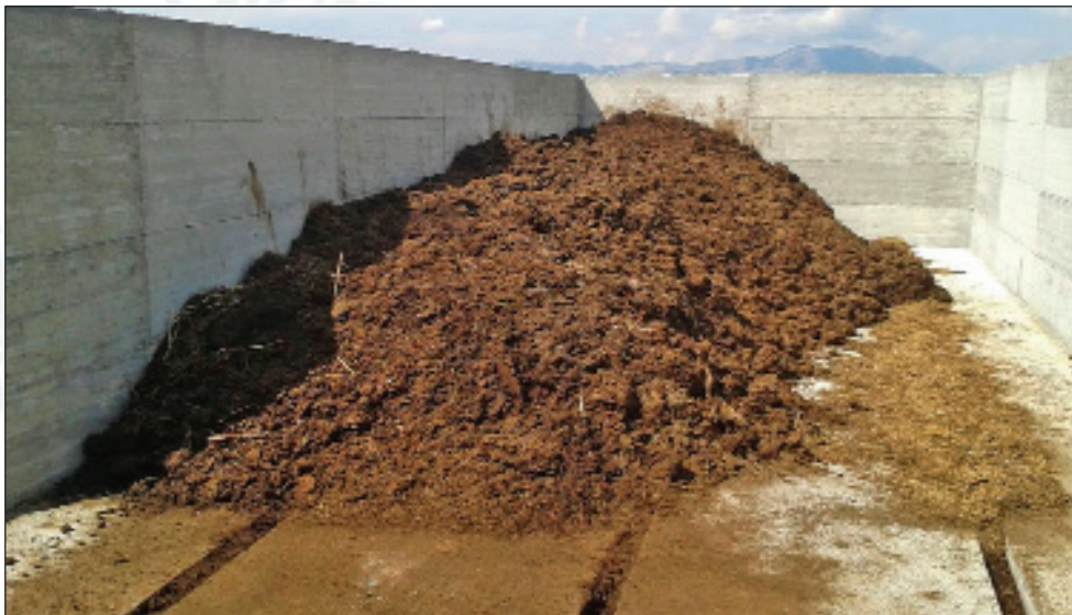
Figura 1. Letame posto a compostare. Sono visibili le canalette in cui saranno sistemati i tubi per l'aerazione forzata, al di sopra dei quali si pone uno strato di materiale strutturante per favorire un arieggiamento uniforme del cumulo.
