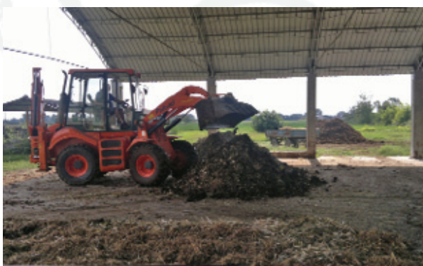
Figura 4. Terna per formazione, rivoltamento e movimentazione cumuli.
