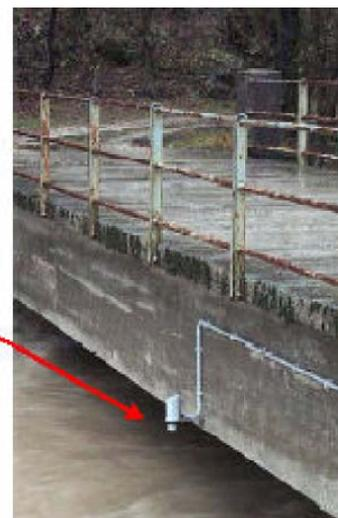
*Sensore ad ultrasuoni per la misura dell'altezza idrometrica*
