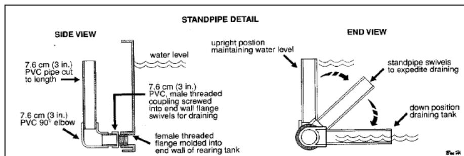
Figura IV.1: Esempio di un sistema di drenaggio basculante.
