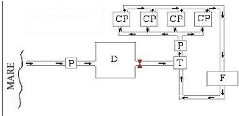
Figura IV.3: Schema di impianto a ciclo chiuso (tratto e modificato da UNEP-MAP 2003; CP= vasca di convascenza o altro, T= controllo termostatico, P= pompa, F= filtro, D= vasca di decantazione).
