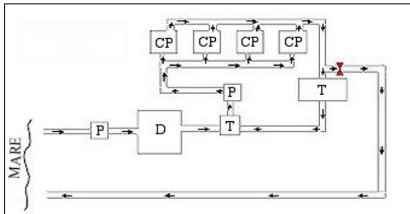
Figura IV.4: Schema di impianto a ciclo semi aperto (tratto e modificato da UNEP-MAP 2003; CP= vasca di convascenza o altro, T= controllo termostatico, P= pompa, F= filtro, D= vasca di decantazione).
