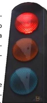
L'innovazione tecnologica ha messo a disposizione nuove lampade semaforiche formate da gruppi di led. La diffusione di queste lampade con attacco standard, che possono essere montate in pochi minuti sugli impianti esistenti è già iniziata da tempo in Stati Uniti e Canada, mentre in Italia si stanno compiendo i primi passi.
