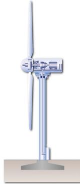
**Figura 3-38 aerogeneratore ad asse orizzontale**
