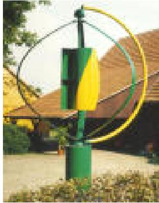
Figura 3-44 Rotore Savonius
