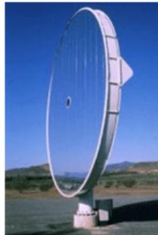
**Figura 3-24** Eliostato a membrana stirata
