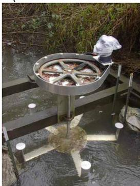
Figura 3-70 Turbina Darrieus per lo sfruttamento della corrente (Alternative Hydro Solutions, 2006)
