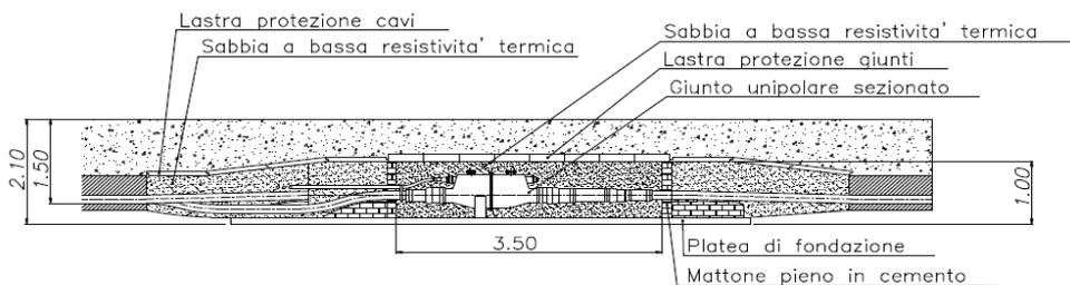
Per quanto rilevato dalla documentazione trasmessa **il progetto prevede esclusivamente la realizzazione di opere interrate**, ovvero cavo interrato, giunti e relativi pozzetti per l'alloggiamento della cassetta di sezionamento delle guaine, posti in opera accanto ad ogni buca di giunzione.
